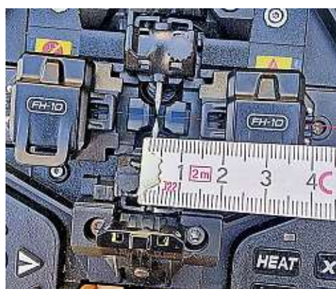
Die Verbindung im Spleißgerät wird mittels eines Lichtbogens hergestellt. Die dünne Linie oberhalb des Zollstocks ist die Glasfaser.
