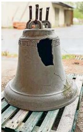
Auf einer Palette auf dem Bauhof-Gelände eingelagert wartet die durch eine Explosion be-schädigte Glocke von Lauta auf die Abholung zur Reparatur.
