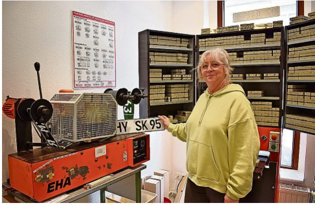
Ute Ulrich an der Heißwalze, wo die Farbe aufgetragen wird, zuvor wird das Kennzeichen an der Presse (im Hintergrund) geprägt. Foto: Juliane Metzsch
