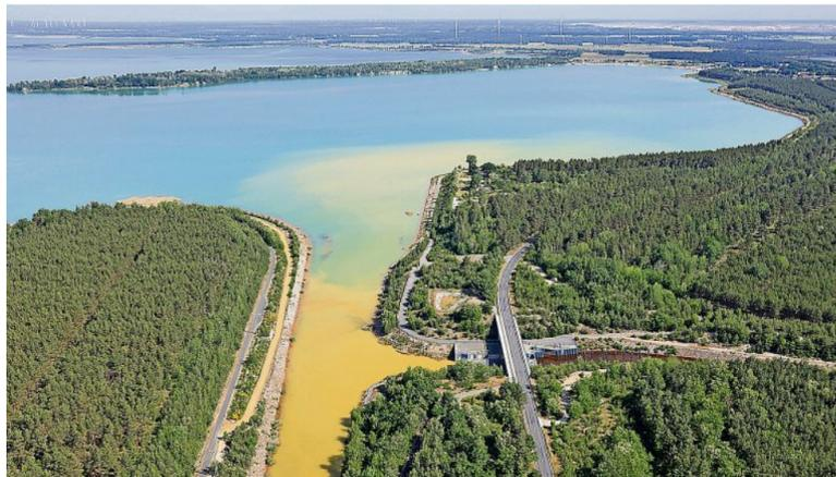
Saures Wasser mit hohem Eisen- und Sulfatanteil greift an einigen Stellen den Beton am Kanal zwischen Neuwieser- und Partwitzer See an.
