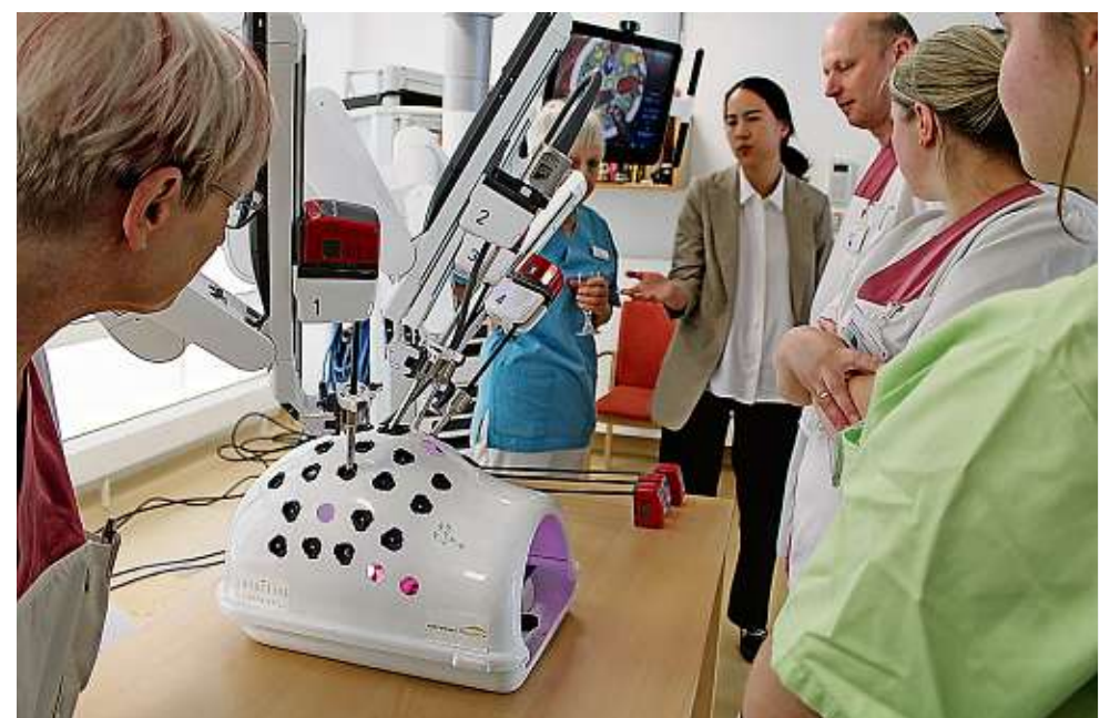
An einem „künstlichen Bauchraum“ kann man mit Da Vinci Xi trainieren. Immer dazu gehören Überwachungsbilder (hinten) für die menschlichen OP-Assistenten. Foto: Mirko Kolodziej
